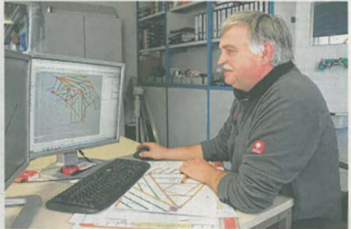
Er setzt die Pläne um: Alfred Döll setzt im Werkstattbüro Pläne der Konstrukteure um. Er gibt die Daten für die CNC-Maschinen ein, die dann die Bleche ausschneiden und -stanzen.
