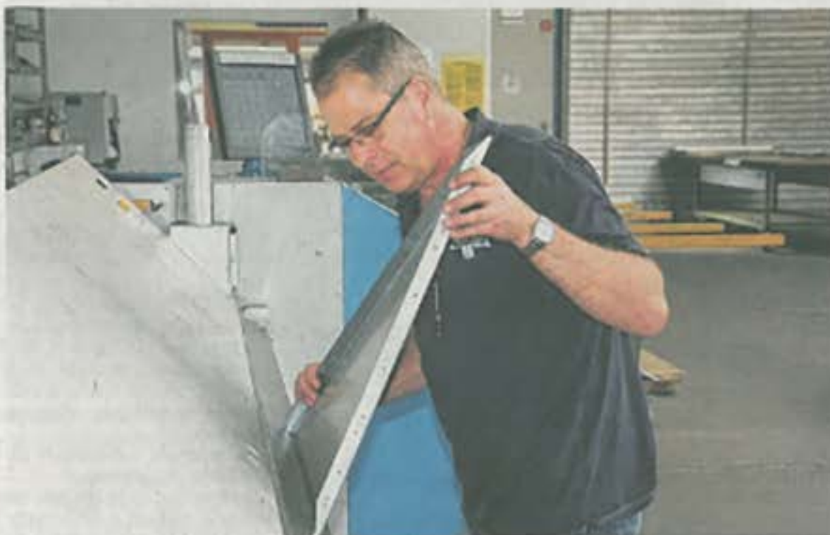
Er leitet die Werkstatt: Horst Wehner an der Abkantbank. Bleche mit Kanten und Falzen zu versehen, gehört zu den Hauptaufgaben im Spenglerhandwerk.
