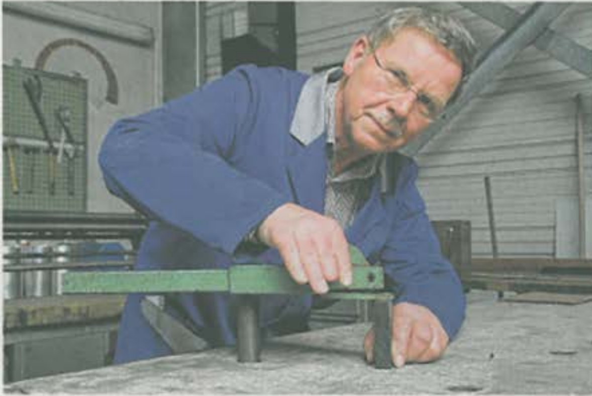
Er erfindet: Friedel Behr mit dem von ihm entwickelten Klemmtisch, an dem sich Werkstücke mit einem Hebeldruck an einer beliebigen Stelle auf der Fläche fixieren lassen.
